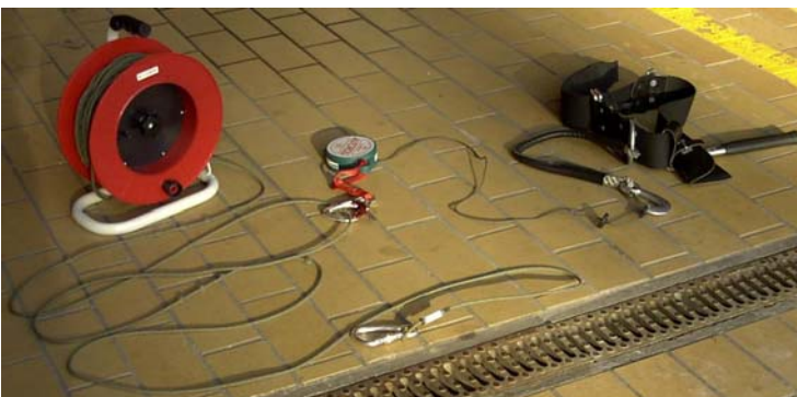
Abb.5 - Die Persönliche Führungsleine (auf der grünen Rolle) ist mittels Karabiner an die Hauptführungsleine (rote Rolle - bei genauem Hinsehen sind auch die Knoten zu erkennen) geklinkt. Das andere Ende der persönlichen Führungsleine befindet sich im Karabiner des Sicherheitsgurtes eingeklinkt. ||Foto: Patrick Fischer||
